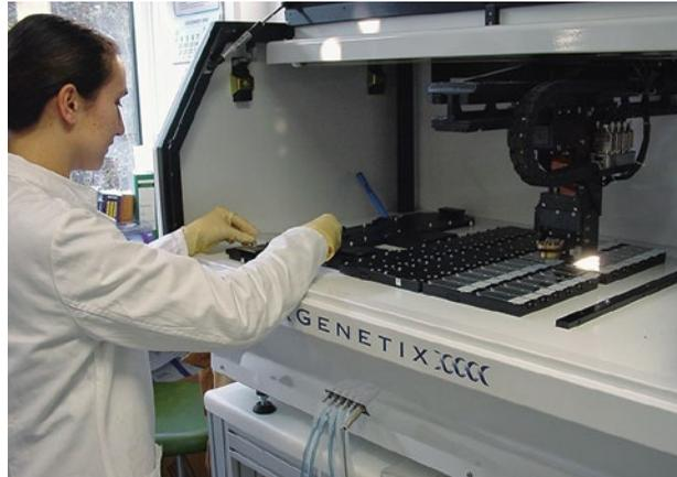
**Microarrayer** zum Spotten von Sonden auf cDNA-Arrays (Chips), um 2004
